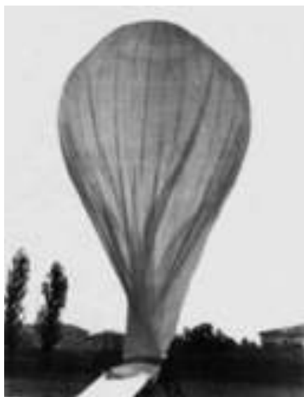
2. Pallone in polietilene per trasporto di emulsioni in alta quota.
