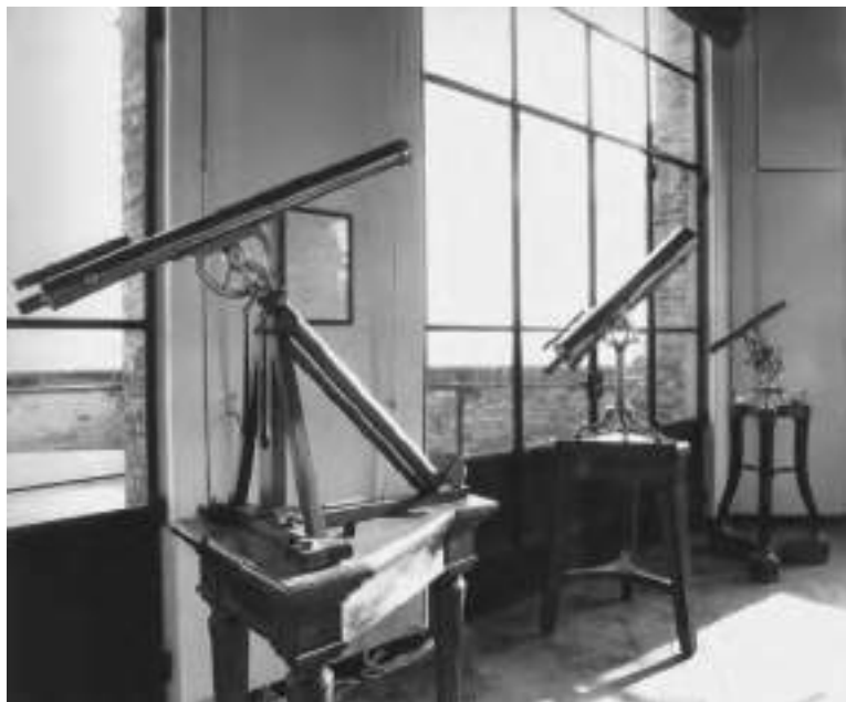
7. Lato est della Sala della torretta con gli strumenti inglesi di Dollond, acquistati nel 1787: in primo piano, lo strumento parallattico, cui segue il telescopio gregoriano, uno dei primi strumenti riflettori a specchio metallico. Sullo sfondo, la macchina equatoriale di Adams (ca.1760). (Foto Marco Ravenna)
