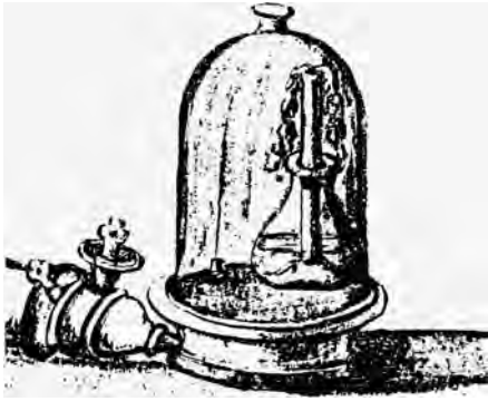
4. La campana pneumatica dalla quale veniva aspirata aria, mediante la macchina di Boyle, nelle pubbliche esperienze dimostrative che i primi Fisiocritici eseguivano a cavallo dei secoli XVII e XVIII.
