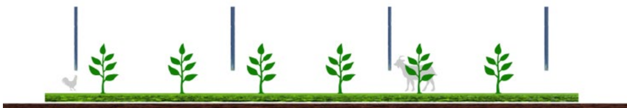
Fig. 3 Sistema agrivoltaico verticale (TIPO 3) 5 .
