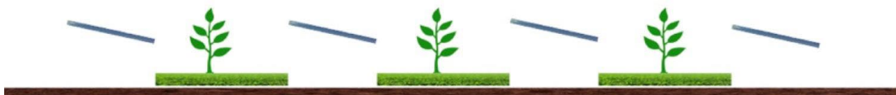
Fig. 2 Sistema agrivoltaico interfilare (TIPO 2) 4 .
